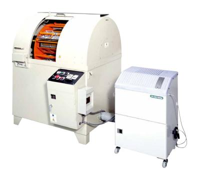
バレル槽をターレット円盤の回転軸心の同心円上に等間隔で分離して数個取付け、遊星運動を行わせて遠心力を与えれば、マスは遠心効果によって槽壁の旋回外周側に固着し、バレル槽内の空間と接する上層部は旋回方向へ移動します。この間、マスは遠心力による圧力と強制流動速度とにより、マス中の遊離研磨石と工作物は流動により相対運動差が生じ研磨作用が起きます。
