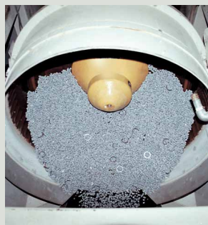
反転排出 Tilting for Unloading
