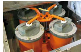
パレル槽クロスSTOPパー Cross Stopper (特許 / Patent No.4189010)
