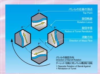
バレル槽をターレット円盤の回転軸心の同心円上に等間隔で分離して数個取付け、遊星運動を行わせて遠心力を与えれば、マスは遠心効果によって槽壁の旋回外周側に固着し、バレル槽内の空間と接する上層部は旋回方向へ移動します。この間、マスは遠心力による圧力と強制流動速度とにより、マス中の遊離研磨石と工作物は流動により相対運動差が生じ研磨作用が起きます。
