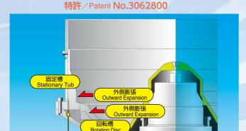
従来型のバレル槽は、固定槽ウレタンと回転槽ウレタンがお互いにクリアランスを狭くする方向へ熱膨張するため、あらかじめクリアランスを大きく設定するか研磨時間を制約する必要がありました。『クリアランスコントロール』機構は、この固定槽ウレタンを回転槽ウレタンと同量・同方向の外側へ熱膨張させることを目的としており、固定槽ウレタンと外側鉄槽の間に空間層を設けることで実現しています。(特許登録済)したがってマス温度が上昇し、ウレタンが熱膨張してもクリアランス量に変化はなく一定に保たれます。また、クリアランスを狭く設定しても研磨時間(※)の制約を必要としません。
