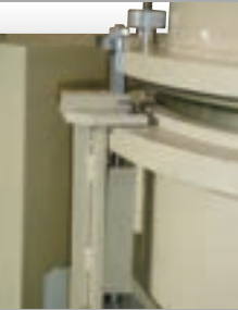
エアシリンダーロック機構 Air Cylinder Lock Mechanism
